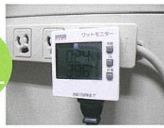
コンセントに取り付ければ家電の消費電力が“見える”!
