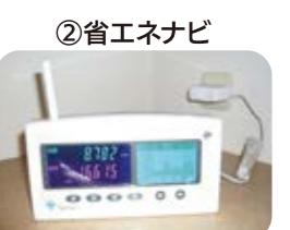
分電盤(ブレーカー)に取り付ければ家や建物全体の消費電力が“見える”!
